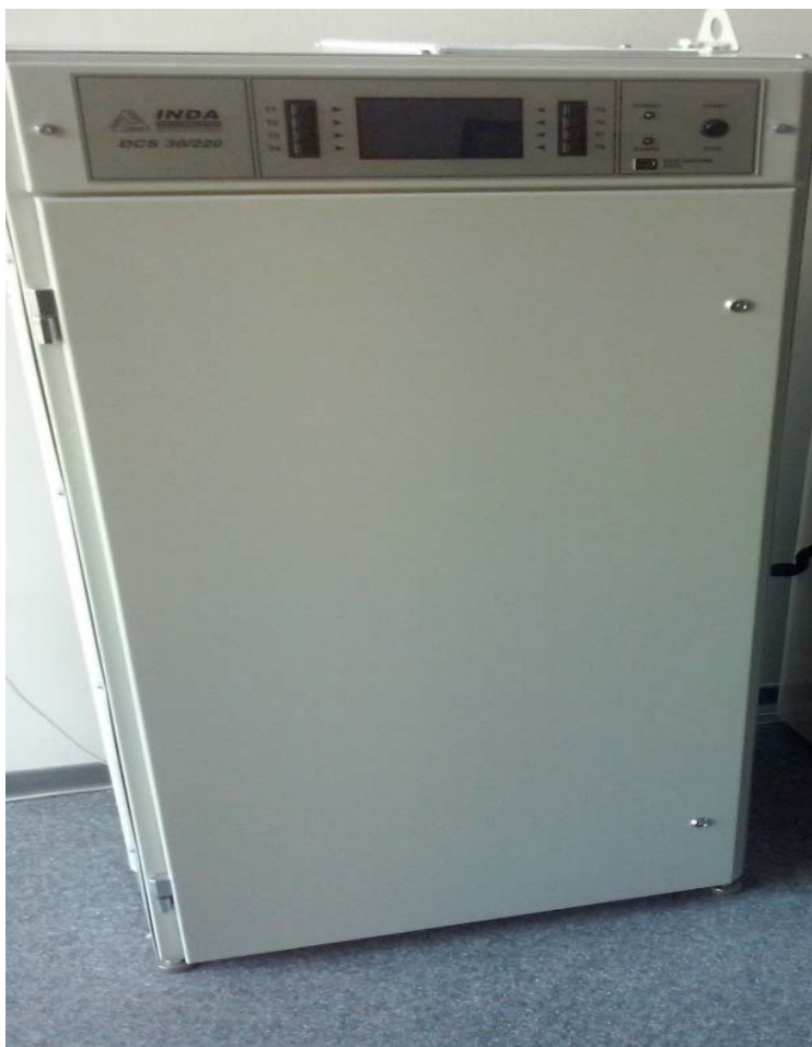
Fig. 4.4. Imagine a sursei comandabile de c.c. care realizează rolul de sursă regenerabilă.
